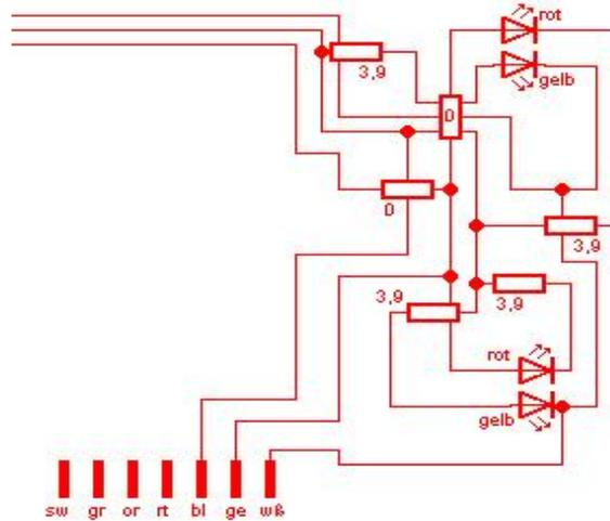
Nun gibt es zwei Möglichkeiten, das zu ändern. Entweder man ändert die Leiterzüge, oder die Doppel-LED werden durch einzelne LED ersetzt; wobei die LED der zweiten Fahrtrichtung entgegengesetzt eingelötet werden. Da ich keine neuen LED zur Hand hatte, blieb nur die erste Variante.
