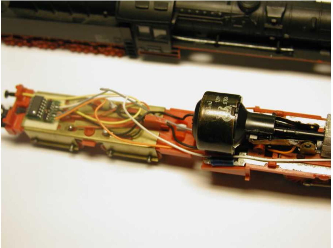
Orange und grau werden am Motor angelötet...
